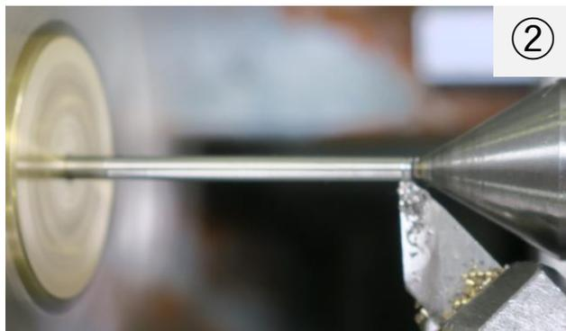
棒が細いので支えが無いと、刃物が当たっている部分が曲がります(図①)。図②のように、右側をセンターで支えて削ります。
